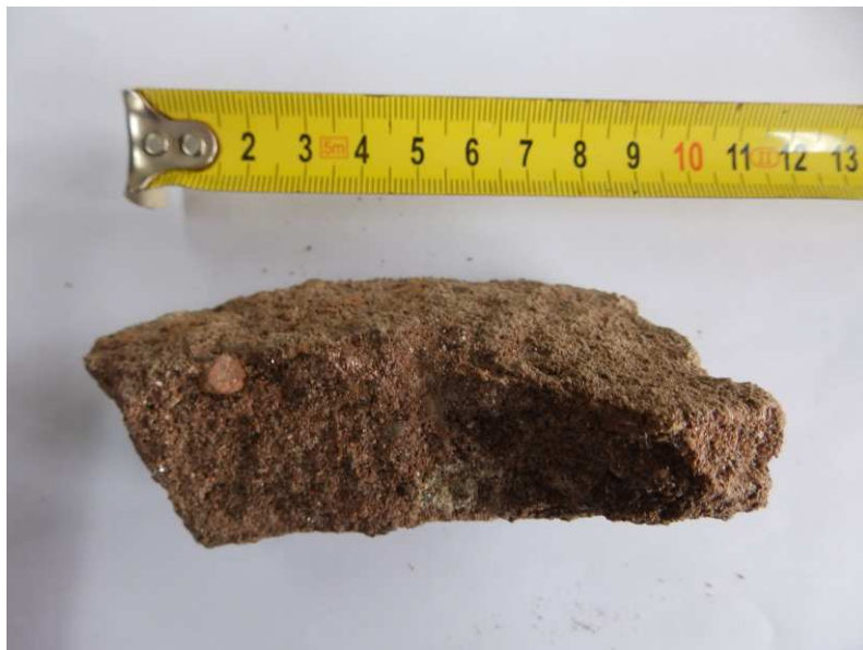
Detail odebraného kusu pískovce nosné konstrukce.
